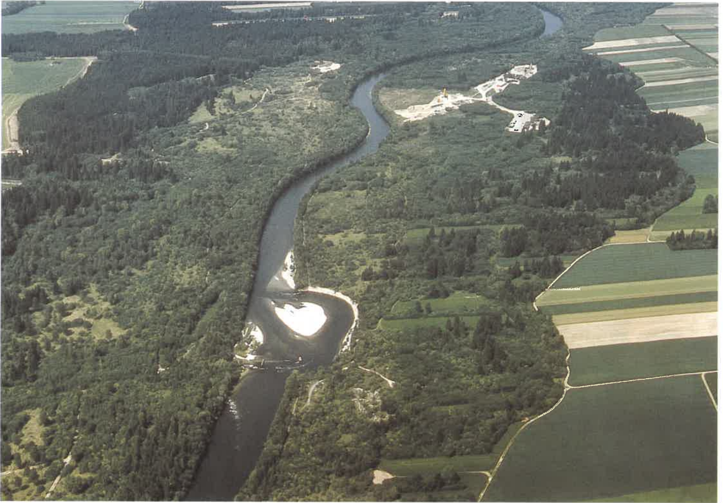
Abb. 12: Durch kanalartige Regulierung wurden die ehemals weit verzweigten Alpenflüsse in ein enges Korsett gepreßt. Regulierter Lech südlich von Augsburg – im Bereich der heutigen Staustufe 21 – die ehemalige Umlagerungsstrecke ist noch am schütterten Bewuchs
